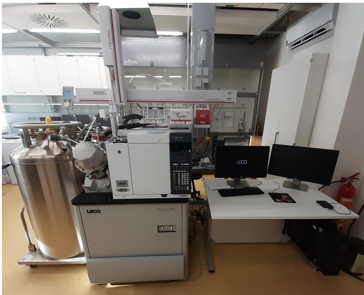
Obrázek 3: Dvoudimenzionální plynový chromatograf GCxGC-MS/FID
